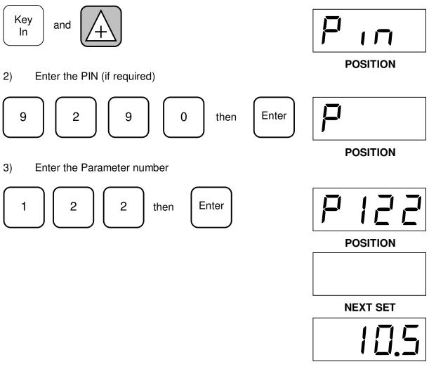
4) Use the layer buttons to alter the parameter value to 11.0mm
